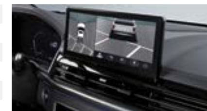
System kamer 360 stopni
