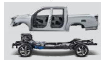
Nadwozie i rama ze stali o bardzo wysokiej wytrzymałości na rozciąganie
